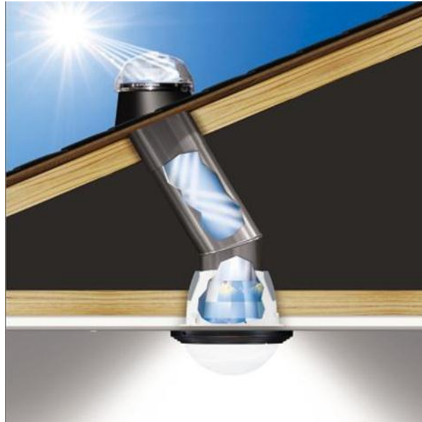
صورة (١) الإنارة بالطرق السالبة للأماكن البعيدة عن ضوء الشمس، عبر ممرات مزودة بمرايا وعدسات توجيه وتكبير الضوء خلال الأسقف للأماكن البعيدة عن ضوءها المباشر. (١٠)
